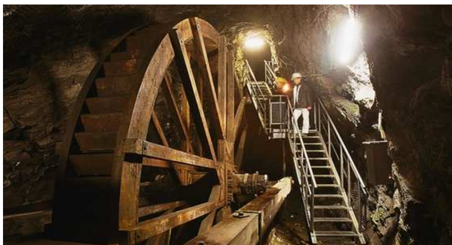
Kunstrad des Serenissoriums – Tiefsten Schachtes im Roederstollen – System Bildquelle : unbekannt
