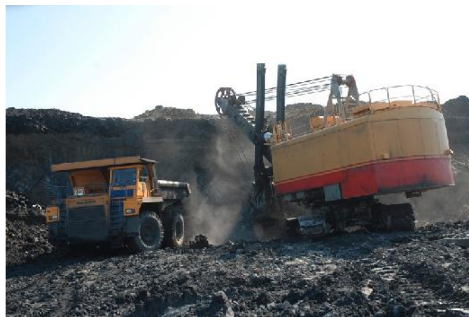
Gewinnung mit Bagger und Dumper
