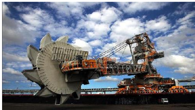
Schaufelradbagger im Rohkohlenbunker
