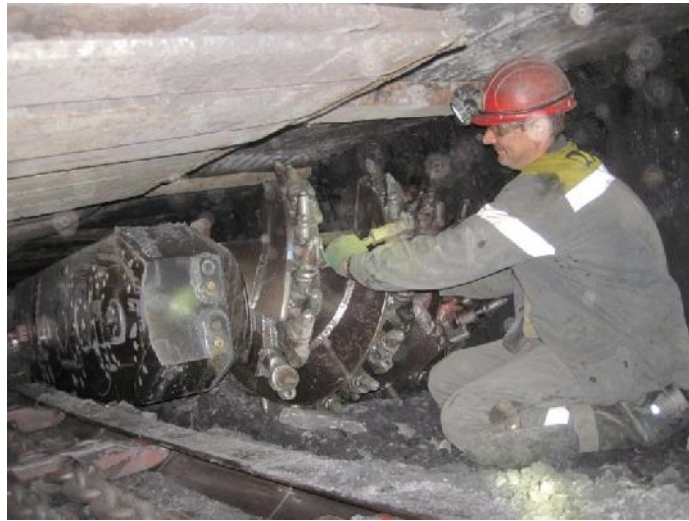
Strebausrüstung mit Walzenlader UKD200-500
