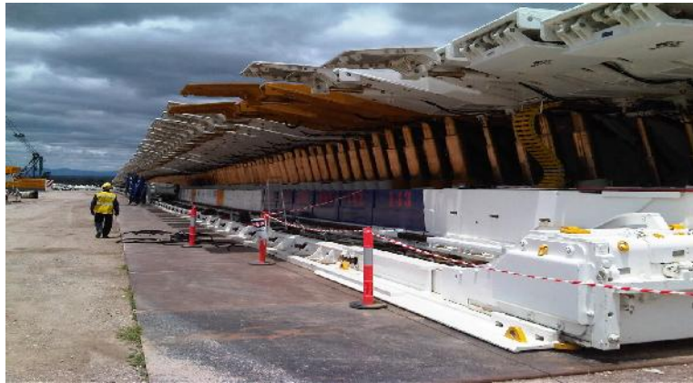
CAT Narrabri Strebearüstung mit Walzenlader Electra EL3000 EVO
