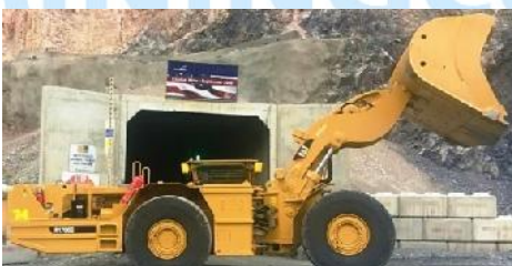
Autonomer CAT-Lader vor dem Stollenportal
